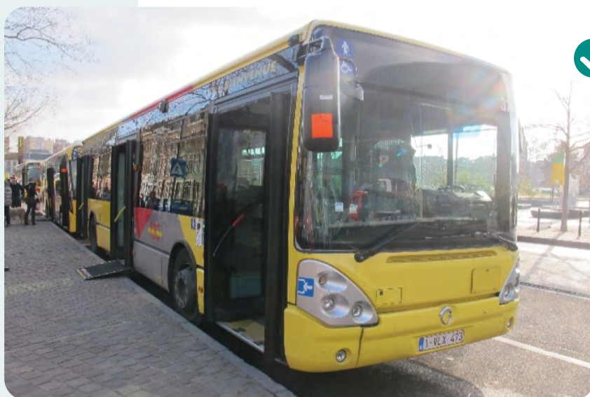
Exemple en Wallonie de bus à plancher bas
