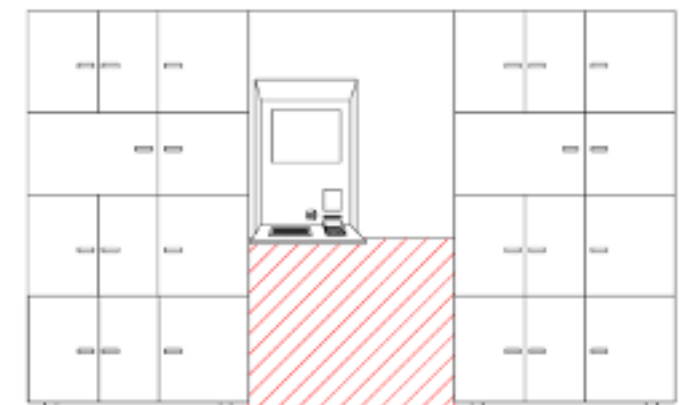
Exemple de consignes avec zone de paiement au centre et zone de dégagement sous la tablette (hachure rouge).
