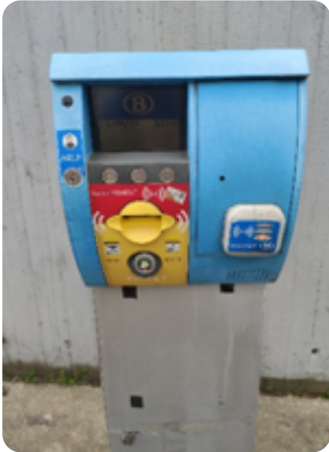
Automate d'accès parking
