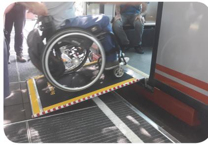
Rampe d'accès de la navette autonome
